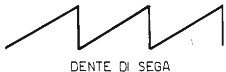
Fig. 3 - Segnale a dente di sega prelevato dall'apposita presa dell'oscilloscopio ed inviato al circuito di entrata del wobbulatore allo scopo di pilotare il diodo varicap.
